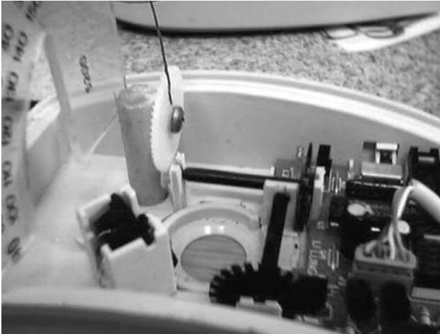
Ilustración 4. Diagrama del dispositivo propuesto para medir la velocidad de un fluido utilizando el "ratón" de una computadora.
